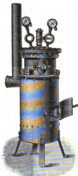
Fig. 31. — Chaudière pour l'essai Erdmenger.
